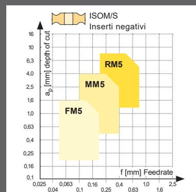
WSM10S/WSM20S/WSM30S: Materiale da taglio con estrema tenacità e resistenza all'usura grazie al nuovo rivestimento Tiger-tec® Silver PVD( $Al_2O_3$ )
